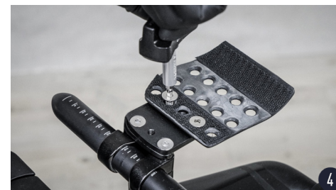
将手肘靠垫延伸座用短锥螺丝，选择左右两边对称的位置，以 5Nm 锁上。
