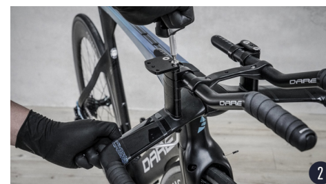
松开螺柱，取下手肘靠垫座 [D7, D8]，调整位置装上延伸片（字母朝下，R 组装在右方，L 组装在左方），重新将螺丝穿过锁上。
