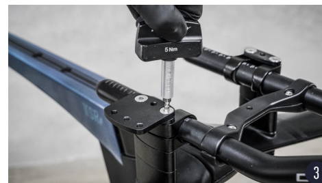
拿 5 号六角板手及 4 号扭力板手将左右延伸片四个螺丝以 5NM 锁紧。
